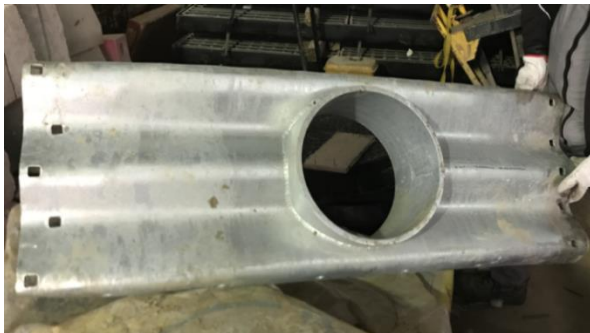
FIGURA 7 Plancha especial adaptada para ser sumidero
